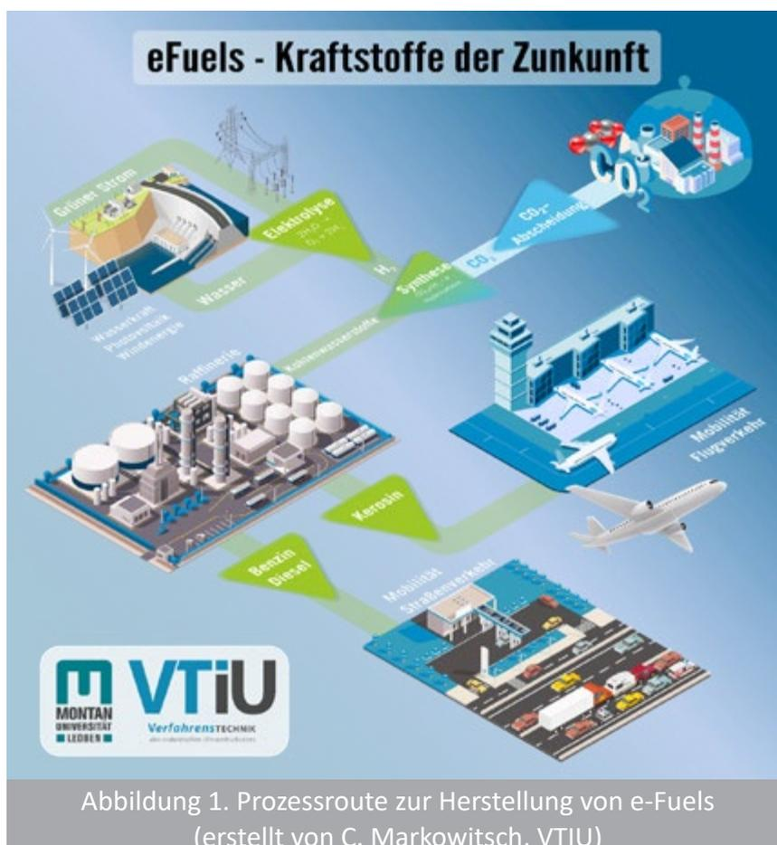
Abbildung 1. Prozessroute zur Herstellung von e-Fuels (erstellt von C. Markowitsch, VTiU)
