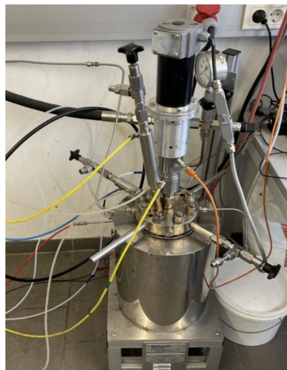
Abb. 3: Für die Karbonatisierung verwendeter Reaktor des VTiU.
